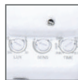
regulacja czujnika LUX / SENS / TIME
