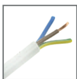
przewód o izolacji polwinilowej (H05VV-F) 3x1.0mm 2
