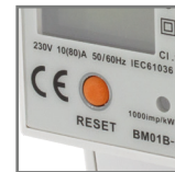
BM01B-L przycisk RESET do kasowania podlicznika
