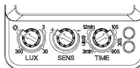
**UWAGA:** podczas testowania urządzenia w warunkach oświetlenia dziennego należy ustawić położenie regulatora LUX w pozycji maksymalnej (SUN), w przeciwnym przypadku praca czujnika może być nieprawidłowa!
