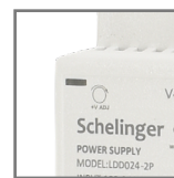
dioda LED sygnalizująca pracę zasilacza
