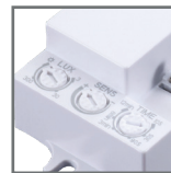
SES75WH regulacja TIME (10s÷12min) i LUX (3÷2000lux)
